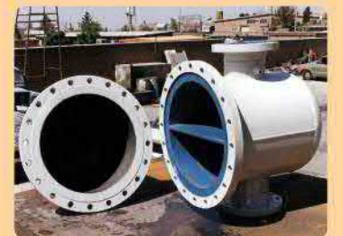
• مبدل‌های خنک‌کننده روغن ژنراتور آبی - کارون ۱ (پروژه زیمنس)
