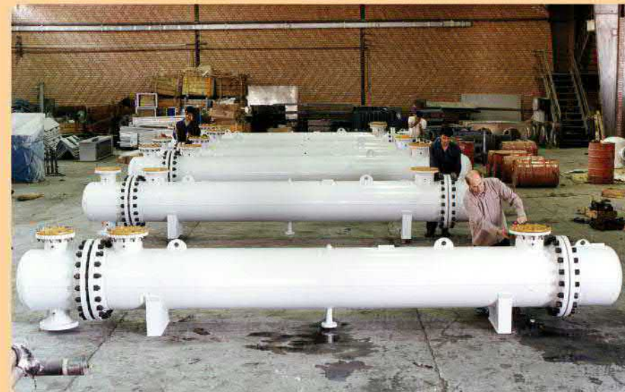
• مبدل‌های خنک‌کننده هوا ژنراتور آبی - کارون ۱ (پروژه زیمنس)
